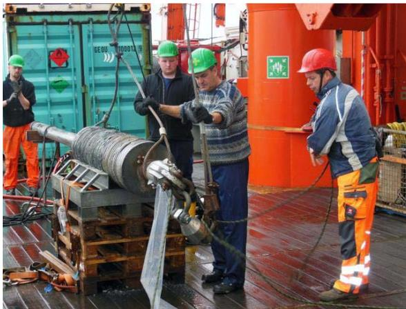
**Abbildung 1:** Einsatz des 3 m langen Schwerelotes zur Beprobung der Schlammvulkanen ohne Kernabsatzgestell.
