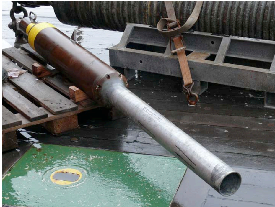
Der als Piezometer umgebaute SmartPlug vor seiner Installation auf KK#4.
