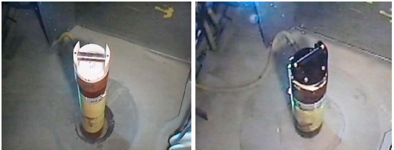
MeBo-Plug (links) und MeBo-CORK-B Vorbereitung (rechts), jeweils kurz nach Terminierung des Bohrlochs und vor Abheben des MeBo vom Meeresboden aufgenommen.
