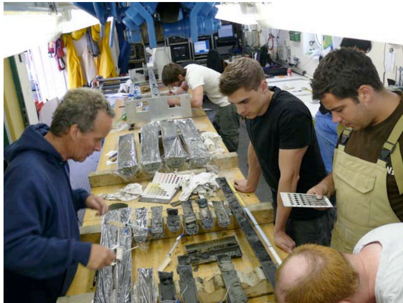
Kernbeschreibung und Porenwasserbeprobung an MeBo-Kernsegmenten und Schwerelotkernen von Schlammvulkan KK#4.
